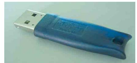
Ein eToken ist eine spezielle Form einer Smartcard, die direkt über den USB-Anschluss des Computers angesteuert werden kann und die Erstellung wie auch die Speicherung von Schlüsseln und Zertifikaten ermöglicht. Der erstellte Private Key wird auf dem eToken sicher verwahrt. Alle Entschlüsselungsroutinen werden auf dem eToken ausgeführt.
